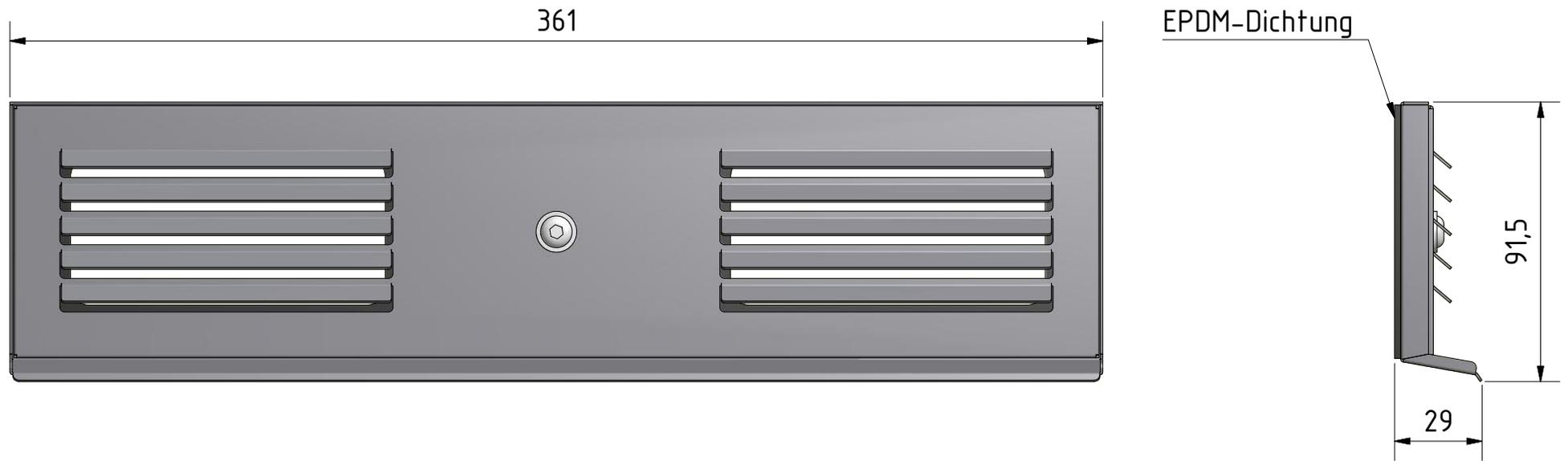
Einbaulage Horizontal für Flachkanalsystem 110 x 54 mm
