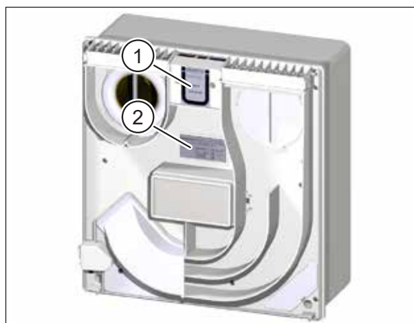
Abb. 3: Lage von Zulassungsnummer und Typenschild
