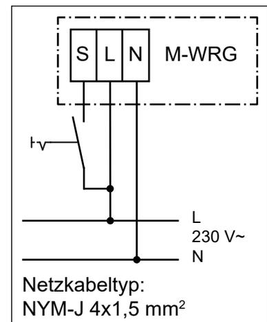
Abb. 16: Anschlussplan für ext. Steuereingang
