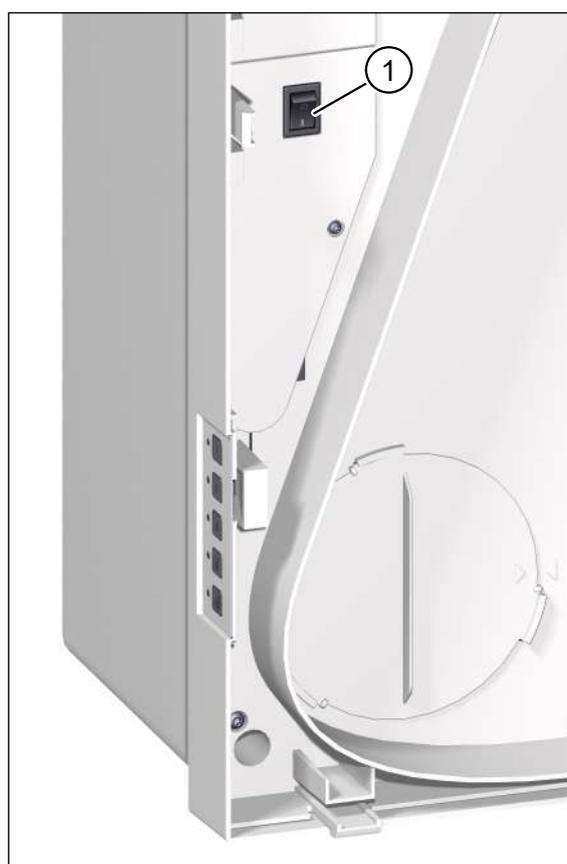
Fig. 14: Interruttore di rete, visibile dopo aver rimosso il coperchio dell'apparecchio
