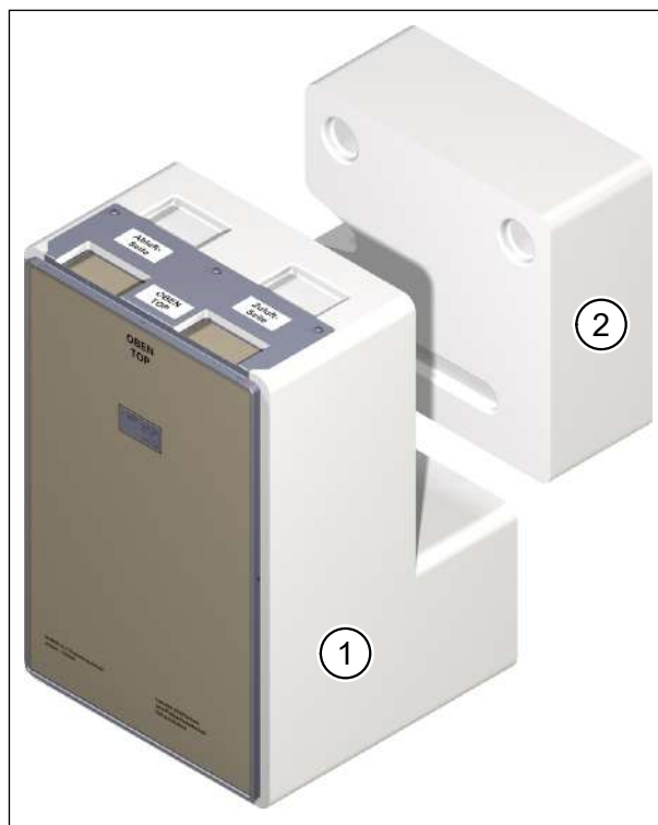
Fig. 1: Set di montaggio M-WRG-II M-U 2 ed elemento di riempimento opzionale M-WRG-II M/Fü
