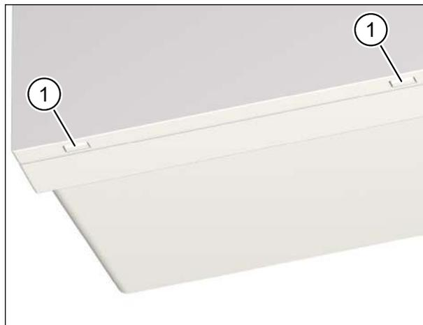
Fig. 19 : Démontez le couvercle de l'appareil d'aération
