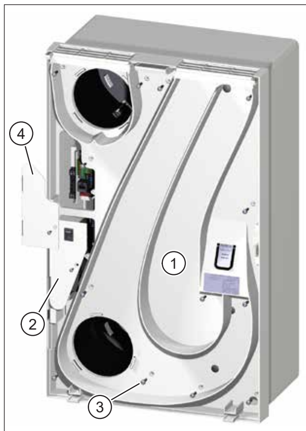
Fig. 26 : Installer et fixer la plaque intermédiaire et les couvercles du système électronique
