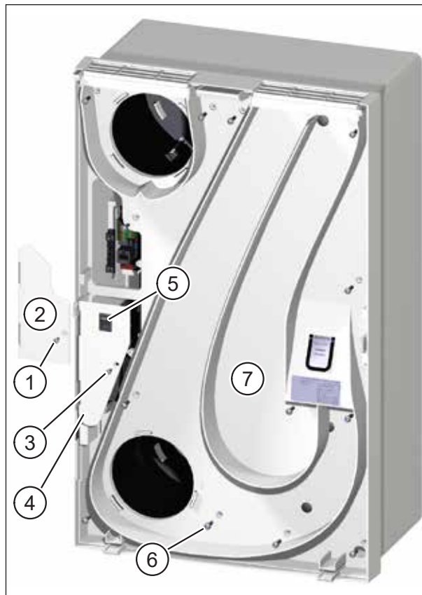
Fig. 23 : Démontez les couvercles du système électronique et la plaque intermédiaire
