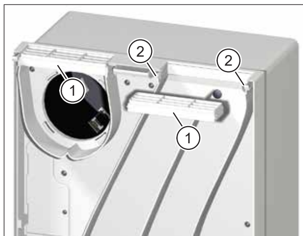
Fig. 10 : Nettoyer la grille à air (en cas de montage en saillie ou encastré sans raccord pour conduit)
