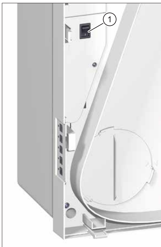
Fig. 4 : Interrupteur d'alimentation, visible après enlèvement du couvercle de l'appareil
