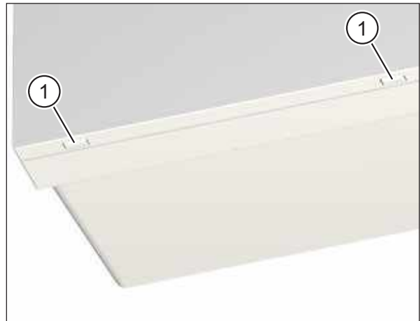
Abb. 25: Gerätedeckel vom Lüftungsgerät abnehmen
