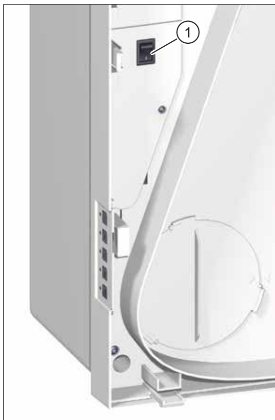
Abb. 9: Netzschalter, sichtbar nach Abnahme des Gerätedeckels
