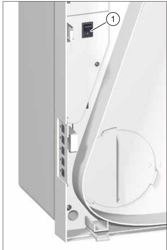
Abb. 11: Netzschalter, sichtbar nach Abnahme des Gerätedeckels
