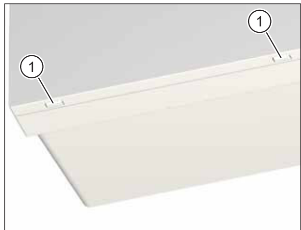
Abb. 22: Gerätedeckel vom Lüftungsgerät abnehmen
