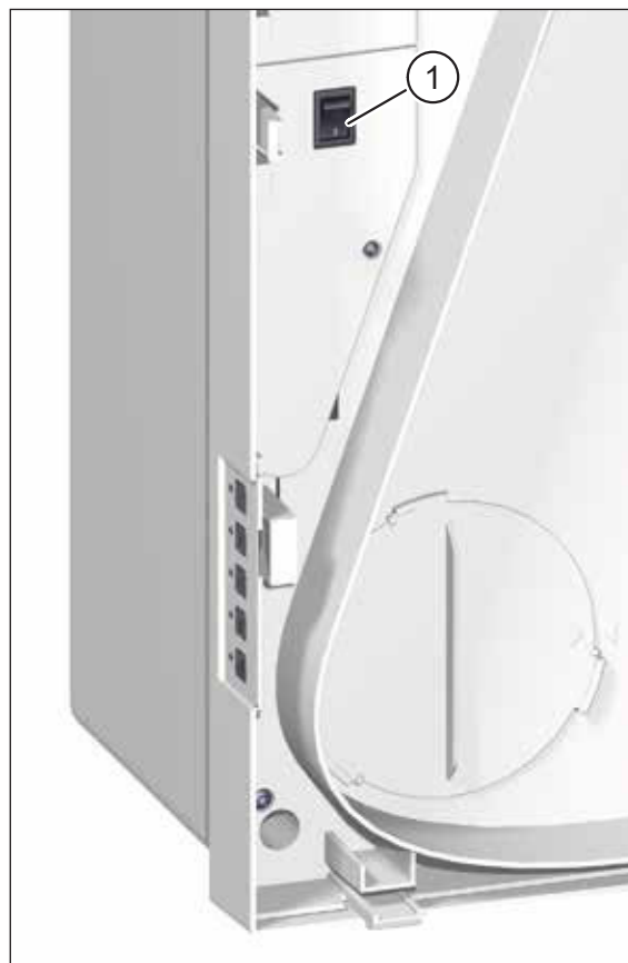
Abb. 14: Netzschalter, sichtbar nach Abnahme des Gerätedeckels
