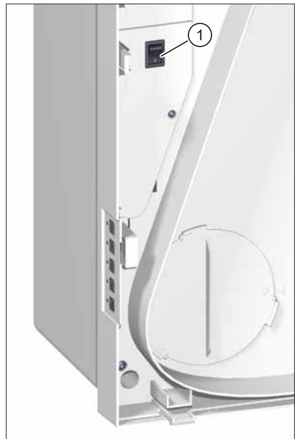
Abb. 14: Netzschalter, sichtbar nach Abnahme des Gerätedeckels
