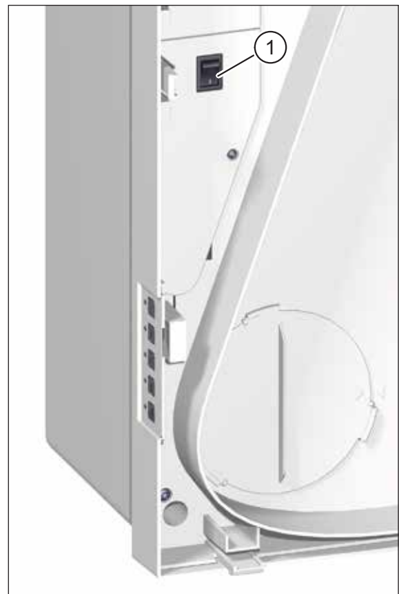
Abb. 13: Netzschalter, sichtbar nach Abnahme des Gerätedeckels
