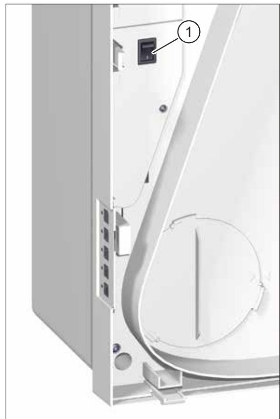
Abb. 12: Netzschalter, sichtbar nach Abnahme des Gerätedeckels
