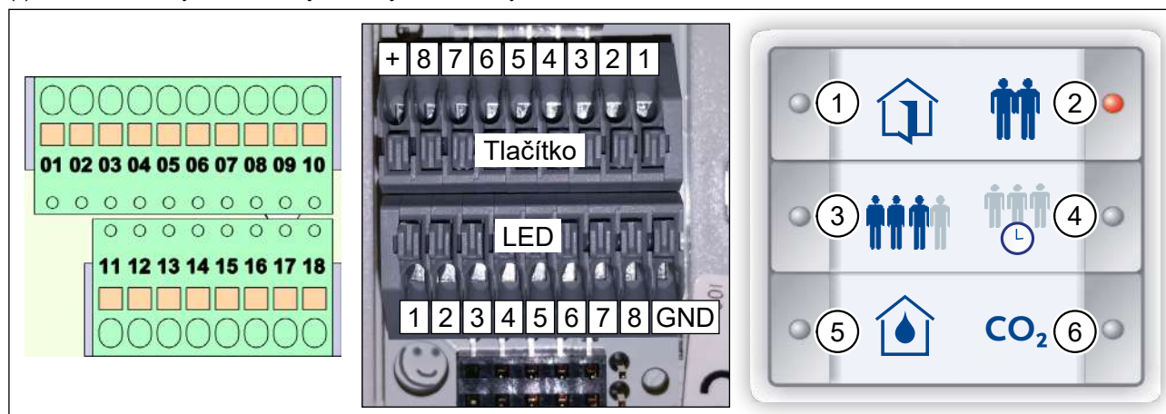
Obr. 32: Svorkové bloky na větrací jednotce, svorkové bloky dotykového senzoru InControl, vkládací list
