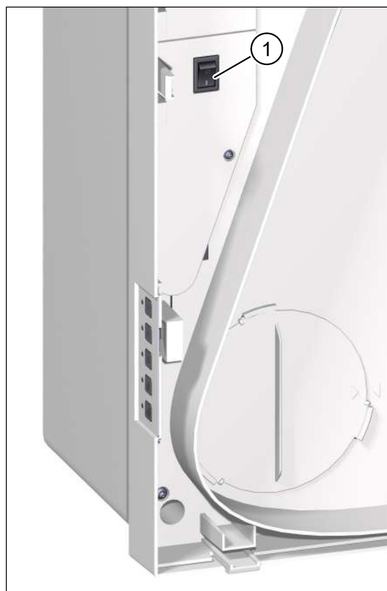
Obr. 18: Síťový vypínač, viditelný po sejmutí víka jednotky
