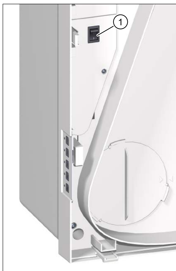
Obr. 4: Síťový vypínač, viditelný po sejmutí víka jednotky
