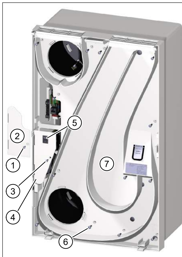
Obr. 23: Sejmutí krytů elektroniky a mezidesky
