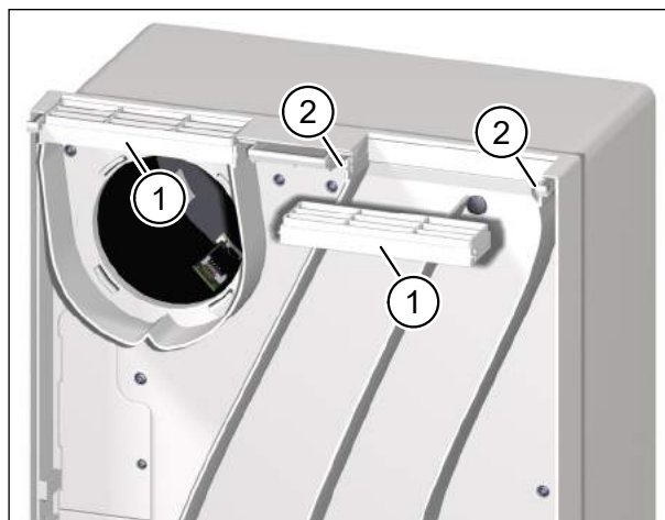
Obr. 10: Očištění vzduchové mřížky (při montáži bez kanálové přípojky na omítku nebo pod omítku)
