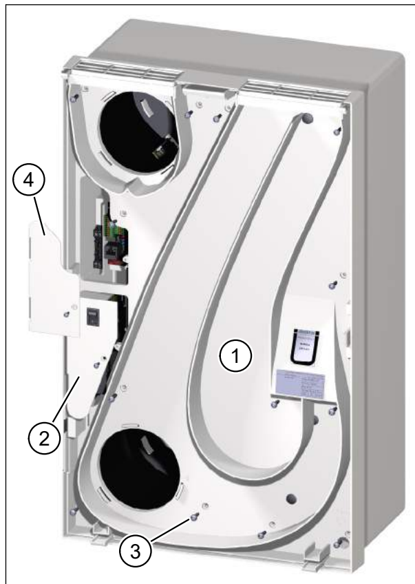
Obr. 26: Nasazení a připevnění mezidesky a krytů elektroniky
