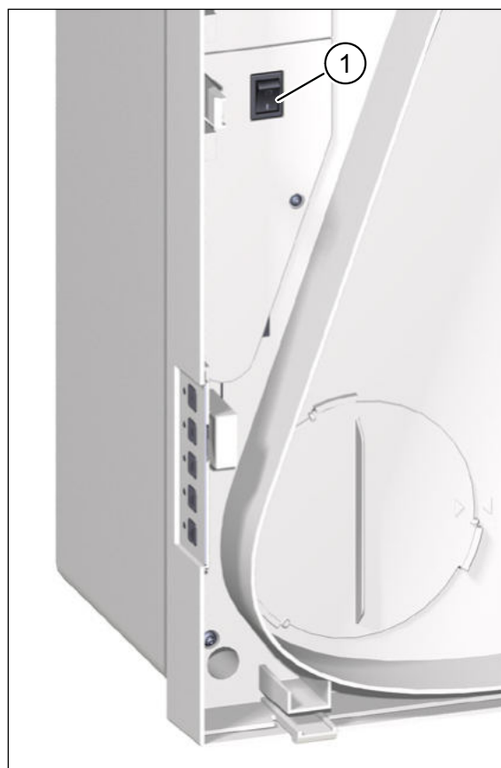
Obr. 13: Síťový spínač, viditelný po sejmutí víka přístroje
