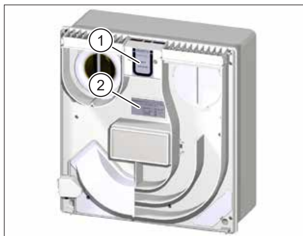
Fig. 4 : Emplacement du numéro d'agrément et de la plaque signalétique
