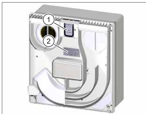
Fig. 3 : Emplacement du numéro d'agrément et de la plaque signalétique
