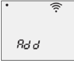
Abb. 9: Neues Lüftungsgerät verbinden
