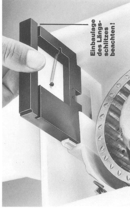
**4.** Klappenträger unterhalb des Ausblasstutzens so einstecken daß der Dichtgummi in Richtung Ausblasstutzen zeigt (siehe Bild). Es ist darauf zu achten, daß die Klappe in ihrem Bett liegt und nicht über den Rand des Klappenträgers vorsteht. Der Klappenträger muß so fest eingedrückt werden, bis die Kunststoffnase an der linken Seite einrastet.
