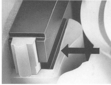
**5.** Abdeckplatte in den Längsschlitz am Klappenträger (Bild oben) stecken und eindrücken, bis beide Rasternasen sowie das Auge einklicken.
