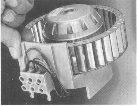
**2.** Netzanschluß an Elektroanschlußteil überprüfen bzw. herstellen.
