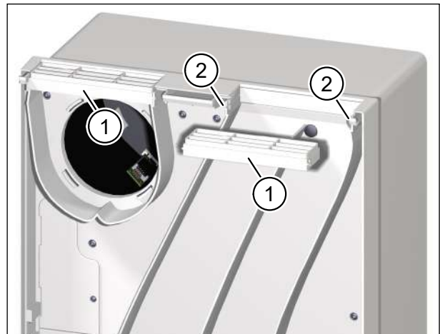
Abb. 10: Luftgitter reinigen (bei Aufputz- oder Unterputzmontage ohne Kanalanschluss)
