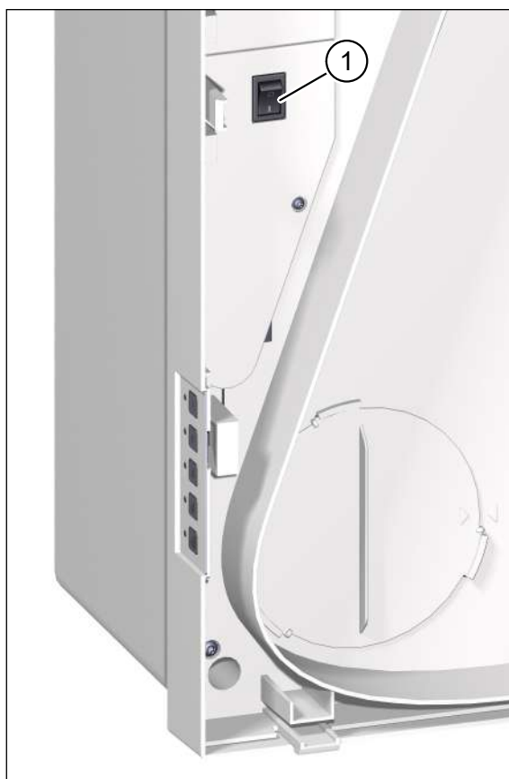
Abb. 4: Netzschalter, sichtbar nach Abnahme des Gerätedeckels
