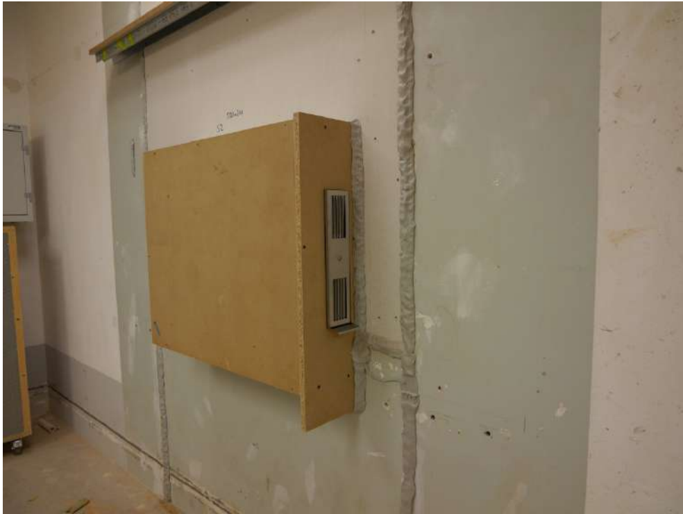
Abbildung C.5. Variante Fensterlaibungslösung: Fassadenabschluss auf der nachgebildeten Fensterlaibung montiert (prüffertig).
