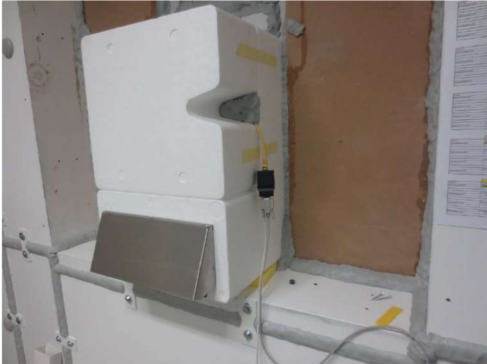
Abbildung E.1. Ansicht Außenseite von schräg rechts (prüffertig): Fassadenabschluss Edelstahlschote auf Mauerkasten montiert.
