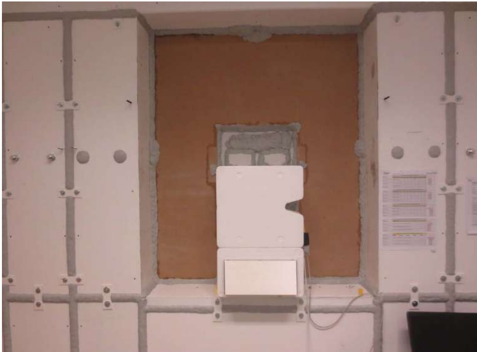
Abbildung E.3. Ein-Raum-Variante: Ansicht Außenseite (prüffertig).
