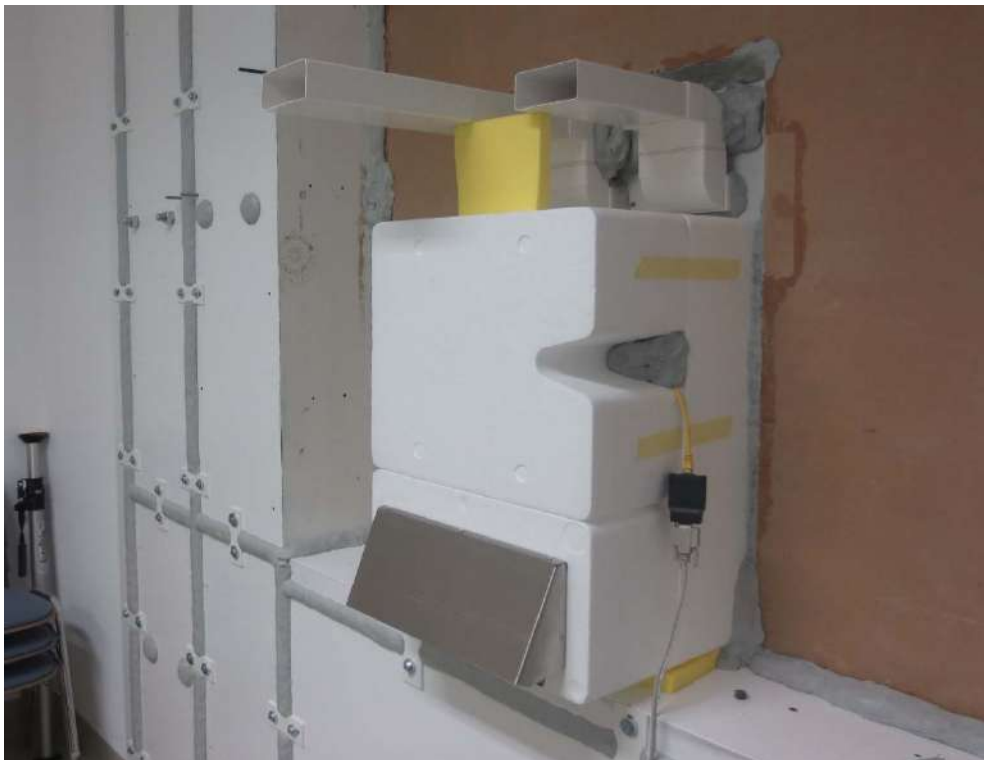
Abbildung E.6. Mehr-Raum-Variante mit Kanalanschluss ABL-+ZUL-seitig: Ansicht Außenseite (prüffertig). Kanalanschlüsse ABL + ZUL nach außen (Senderraum) geführt.
