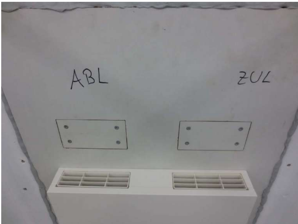
Abbildung E.10. Ein-Raum-Variante: Ansicht Innenseite oben mit Lüftungsöffnungen ABL links und ZUL rechts (prüffertig).
