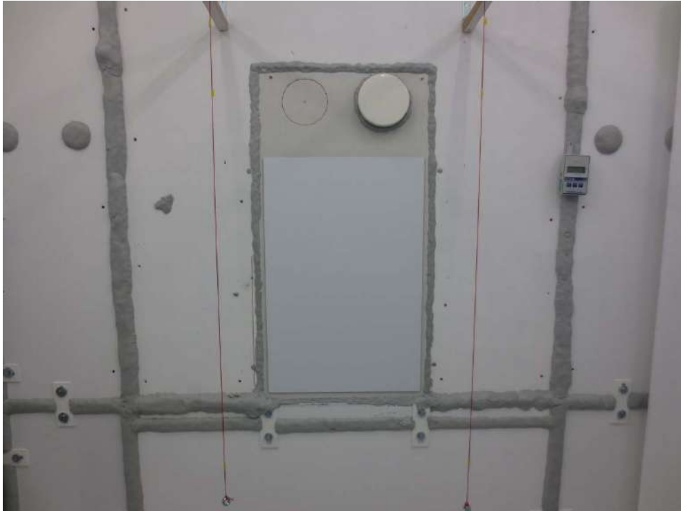
Abbildung D.9. Prüfvariante mit Kanalanschluss ABL-seitig: Frontalansicht Innenseite (prüffertig).
