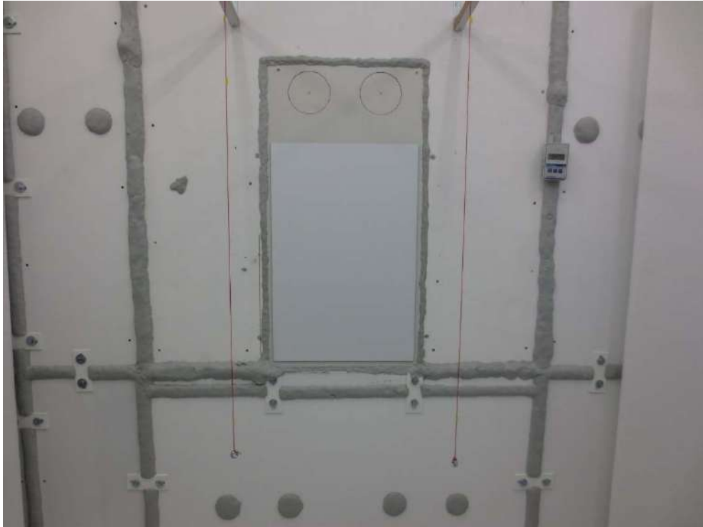
Abbildung D.13. Prüfvariante mit Kanalanschluss ABL- und ZUL-seitig: Frontalansicht Innenseite (prüffertig).
