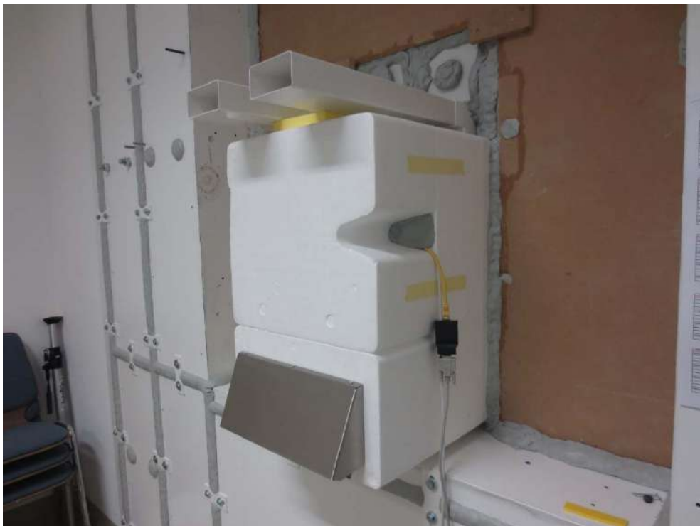
Abbildung D.8. Prüfvariante mit Kanalanschluss ABL- und ZUL-seitig: Ansicht Außen- seite (prüffertig). Kanalanschlüsse ABL und ZUL nach außen (Senderraum) geführt.
