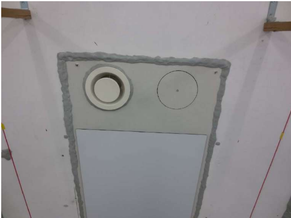
Abbildung D.12. Prüfvariante mit Kanalanschluss ZUL-seitig: Ansicht Innenseite oben mit ABL-Öffnung (prüffertig).
