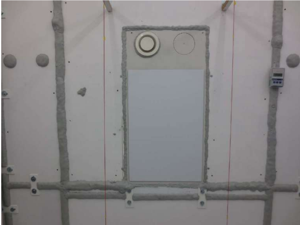
Abbildung D.11. Prüfvariante mit Kanalanschluss ZUL-seitig: Frontalansicht Innenseite (prüffertig).
