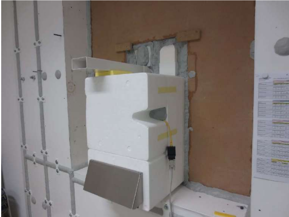
Abbildung D.7. Prüfvariante mit Kanalanschluss ZUL-seitig: Ansicht Außen- seite (prüffertig). Kanalanschluss ZUL nach außen (Senderraum) geführt.
