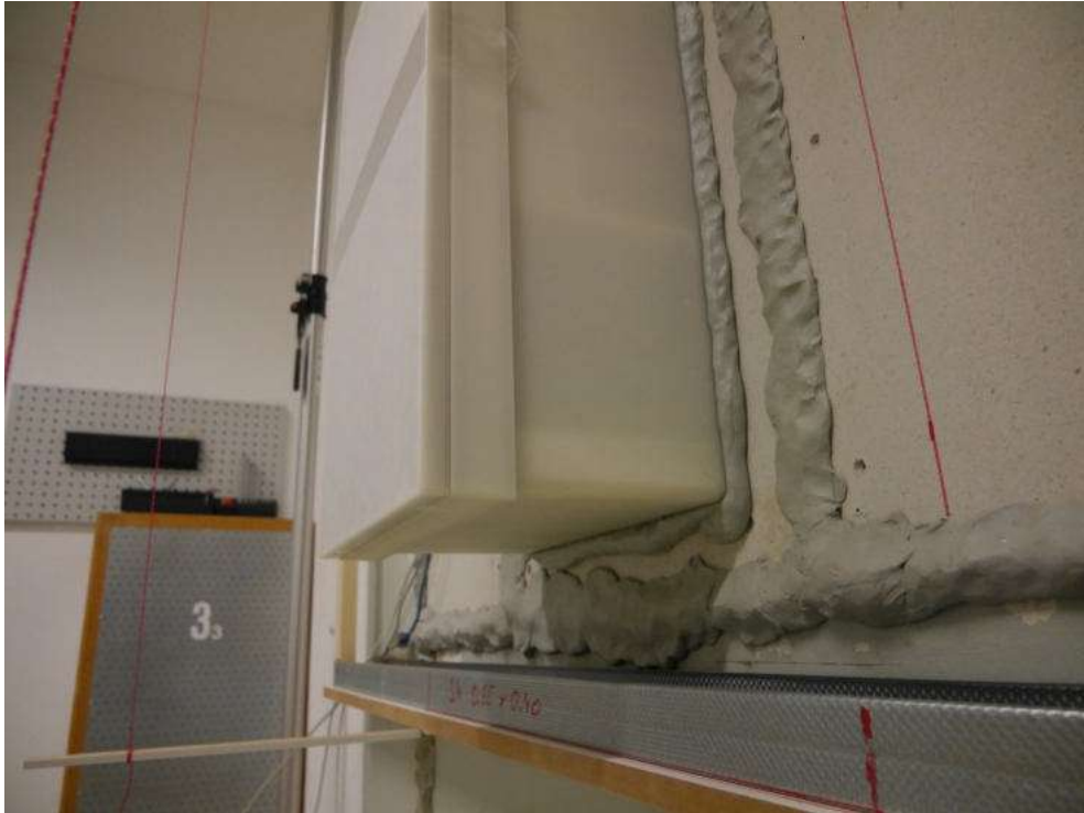
Abbildung B.11. Ansicht Lüftungsgerät innenseitig, prüffertig im Fensterprüfstand montiert und abgedichtet, Seitenansicht von schräg unten.
