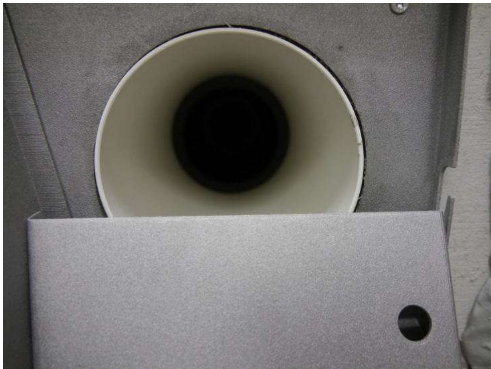
Abbildung B.8. Lüftungsrohr AUL, Variante mit Schalldämmeinlage (Prüfungen 3 und 4).
