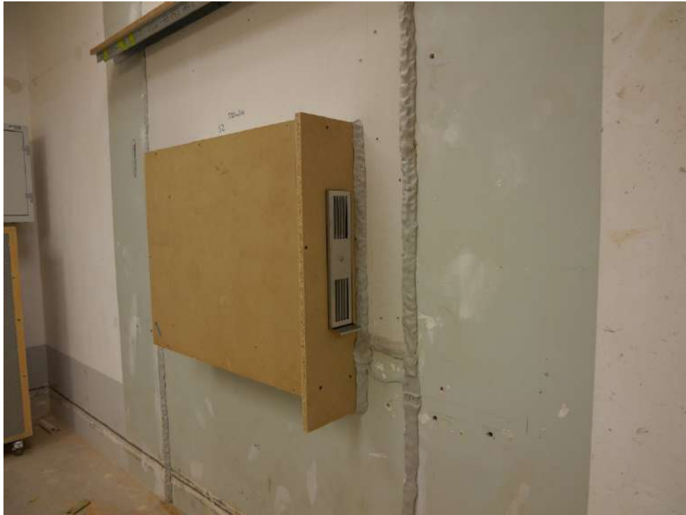
Abbildung B.3. Prüfaufbau im Fensterprüfstand senderaumseitig (Außenseite): Fassadenabschluss Fensterlaibung auf der nachgebildeten Fensterlaibung montiert (prüffertig).
