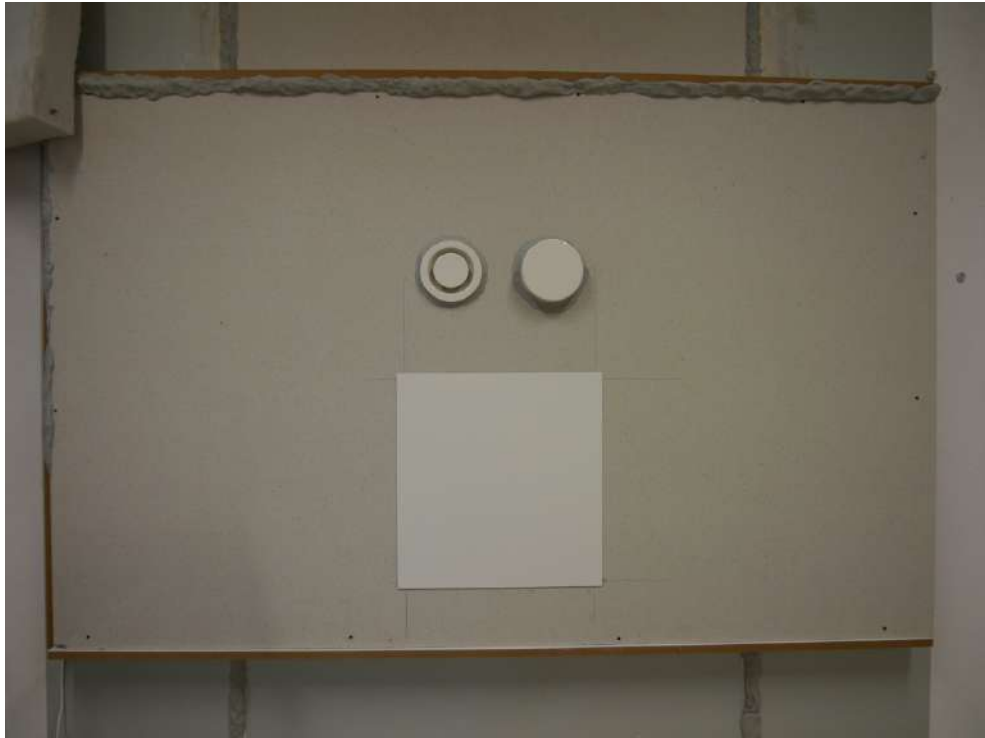
Abbildung B.11. Einbauvariante U 2 : Raumseitige Ansicht Lüftungsgerät; Standardeinbau Ein-Raum-Variante prüffertig, Tellerventil ABL bzw. ZUL und Abdeckung U 2 montiert.
