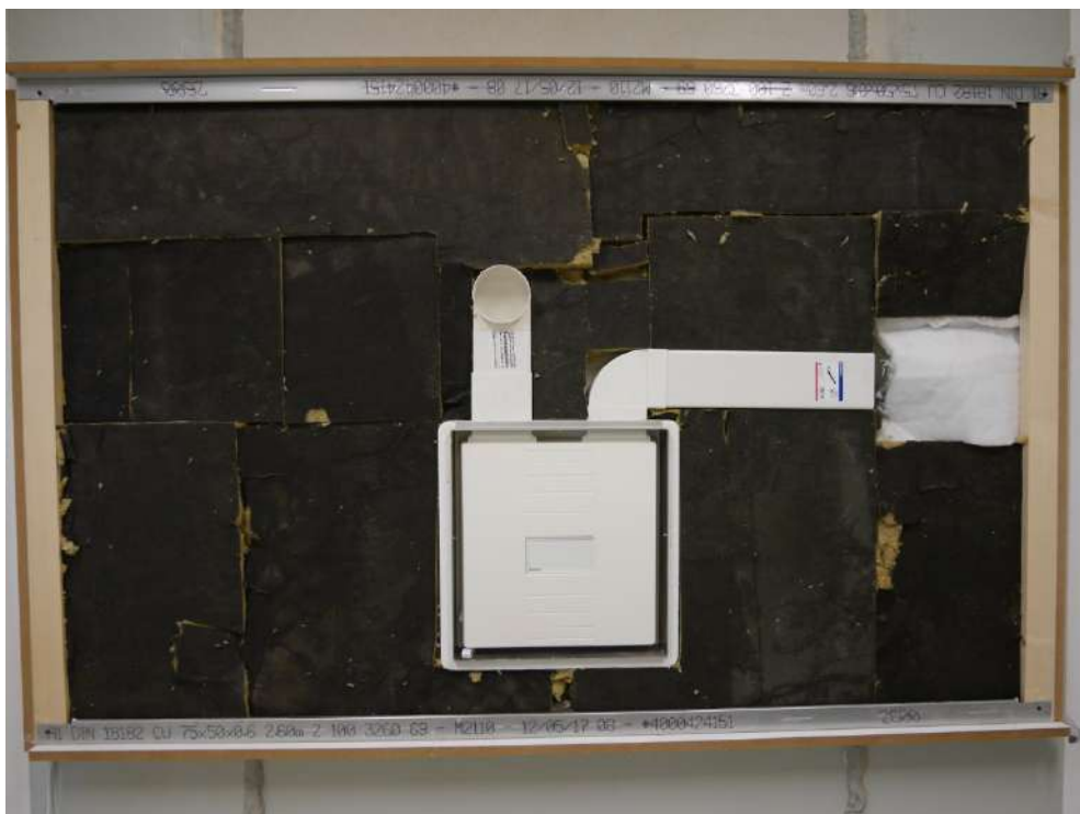
Abbildung B.12. Einbauvariante U 2 : Raumseitige Ansicht Lüftungsgerät mit montierten Lüftungskanälen für Variante Zwei-Raum-Einbau ZUL-seitig; Zustand vor dem Schließen der Vorsatzschale.
