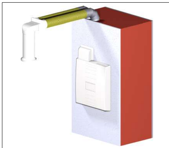
Abb. 4: Unterputzmontage mit Kanalanschluss
