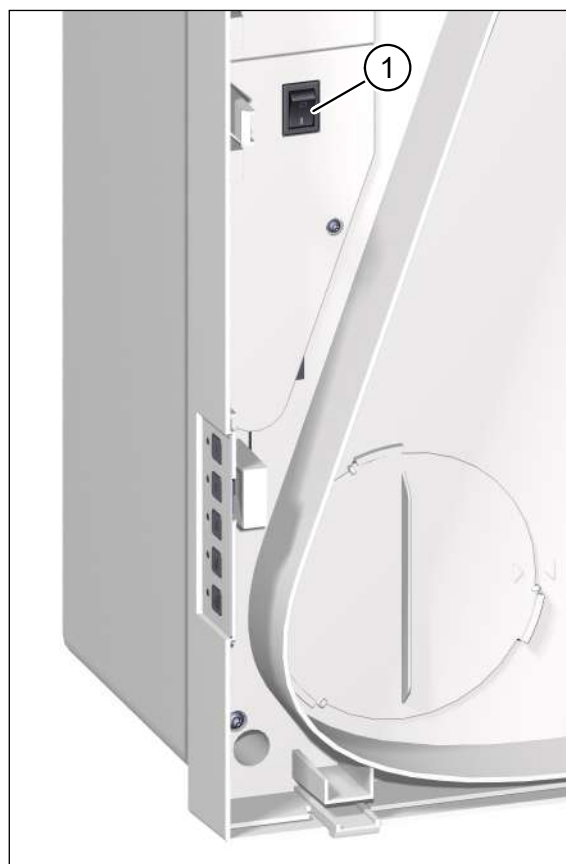
Abb. 13: Netzschalter, sichtbar nach Abnahme des Gerätedeckels
