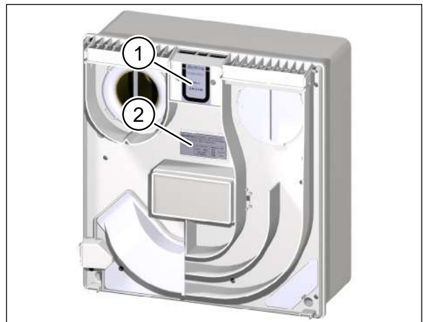
Abb. 4: Lage von Zulassungsnummer und Typenschild
