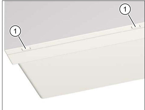
Abb. 19: Gerätedeckel vom Lüftungsgerät abnehmen
