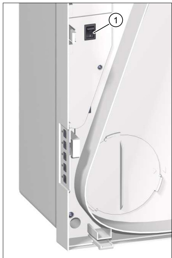
Abb. 14: Netzschalter, sichtbar nach Abnahme des Gerätedeckels
