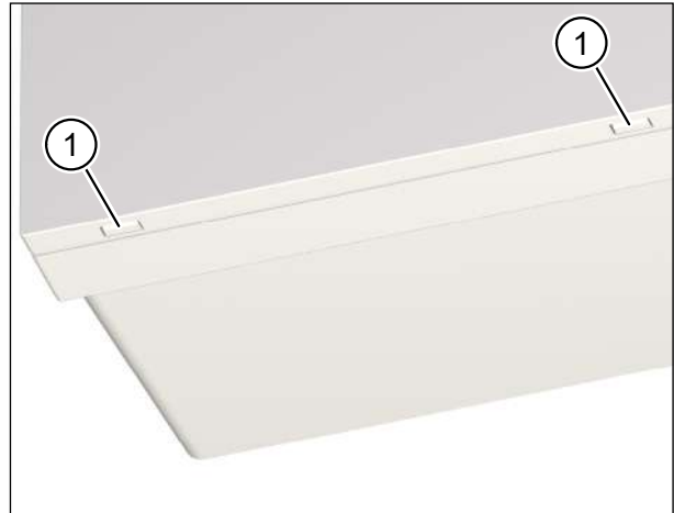
Abb. 34: Gerätedeckel vom Lüftungsgerät abnehmen
