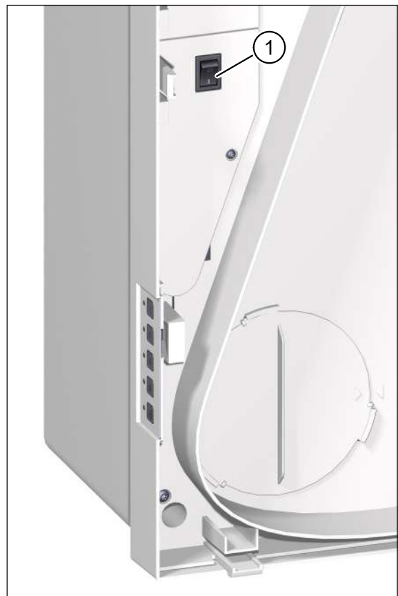
Abb. 18: Netzschalter, sichtbar nach Abnahme des Gerätedeckels
