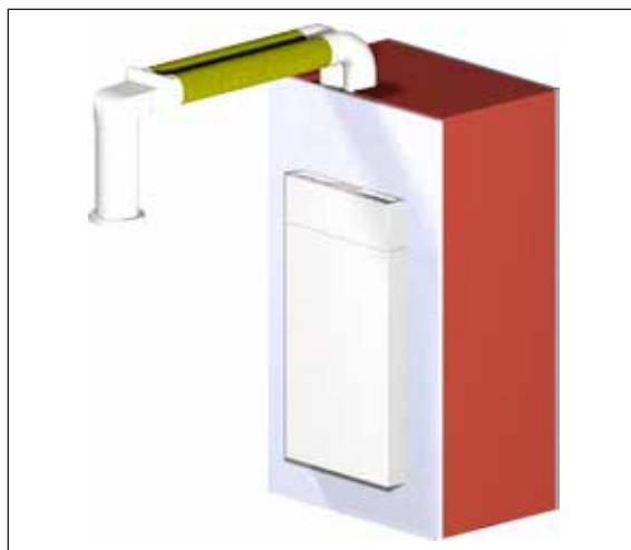
Abb. 4: Unterputzmontage mit Kanalanschluss
